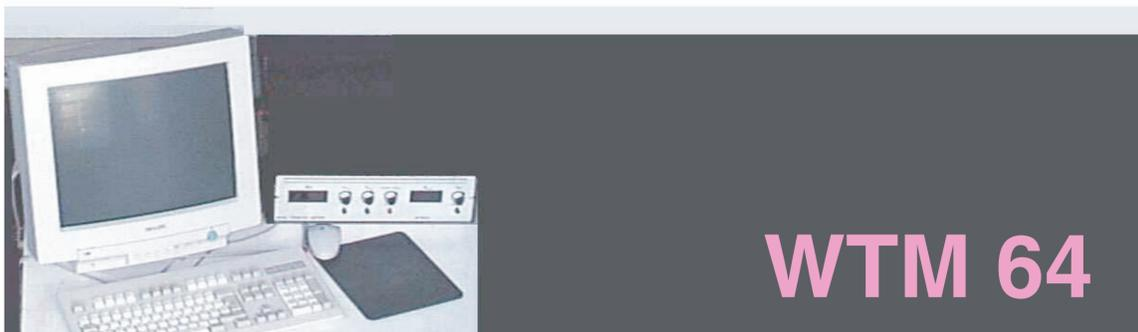
Das **Wire Tension Meter 64** mißt die jeweilige Resonanzfrequenz  $f$  von 64 Drahten *gleichzeitig*. Daraus lassen sich die *mechanischen Spannungen*  $F$  der Drahte bestimmen:
